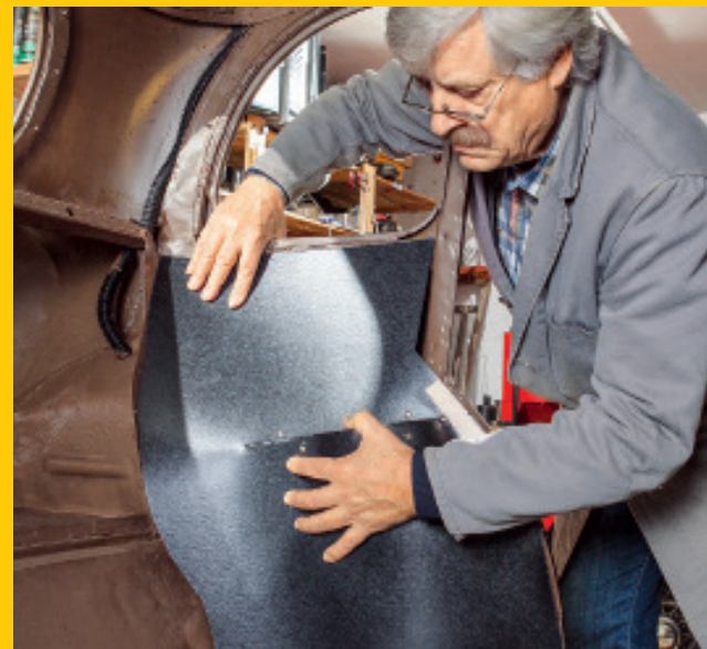
Die Innenverkleidungen fehlten größtenteils. Der Restaurierer bildete die Formen aus Karosseriepappe nach
