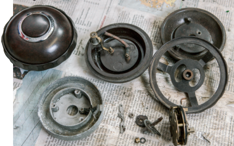
Sorgte für Kopfzerbrechen: Unter dem Hupenknopf im Lenkrad verbirgt sich ein Uhrwerk zur automatischen Blinkerrückstellung
