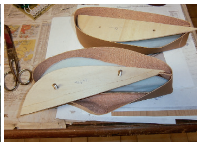
Die Armauflagen der Türverkleidungen werden selbst gefertigt. Ursula Prechsl nähte die PVC-Bezüge (links.). Filigranarbeit verlangte auch der Zylinderkopf (rechts)
